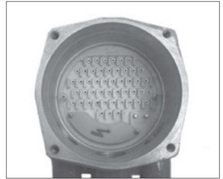
Internal earth stud
