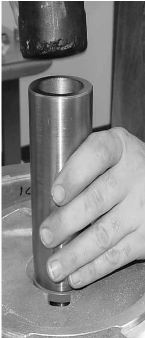
Instalación del sello de labio.
