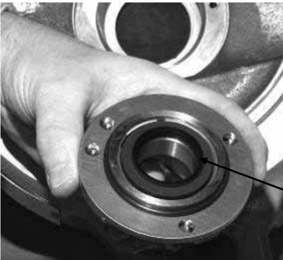
**PASO 14.** Voltee el sello mecánico e inspeccione con cuidado las superficies en busca de partículas abrasivas, desgaste excesivo del sello y acción de retención de la arandela del sello.
