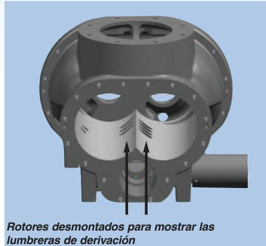
*Rotores desmontados para mostrar las lumbreras de derivación*
