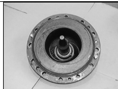
Fig. 8-1: Eje dentro de su alojamiento en la tapa.
