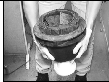
Fig. 7-18: Remoción del imán interior del conjunto impulsor.
